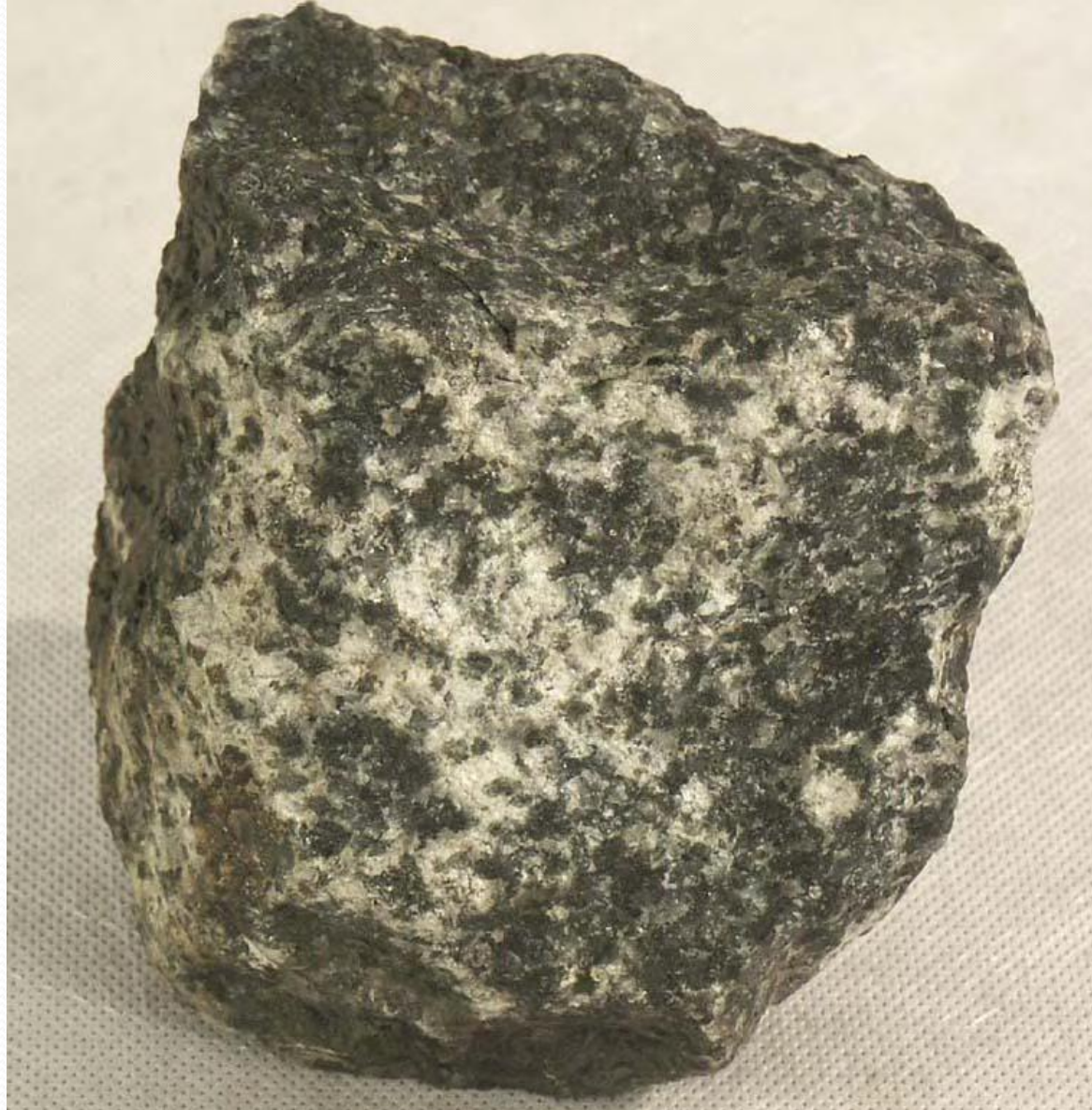
岩石名称：角闪辉长岩 英文名称：Hornblende gabbro 颜色：黑灰 构造：斑杂状构造 结构：粗粒结构 主要成分：碱性斜长石、普通辉石、普通角闪石 所属岩类：岩浆岩\碱性深成侵入岩 产地：湖北随县
