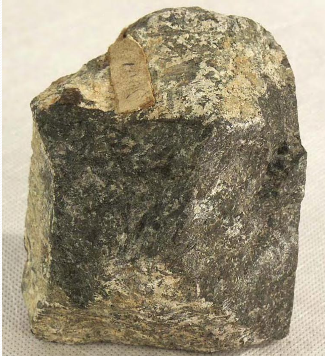
岩石名称：霓霞钠辉岩（暗霓霞岩） 英文名称：Melteigite 颜色：灰黑 构造：块状构造 结构：粗粒结构 主要成分：霞石、霓辉石、黑云母、黑榴石 所属岩类：岩浆岩\碱性-碱性深成侵入岩 产地：云南鸡街
