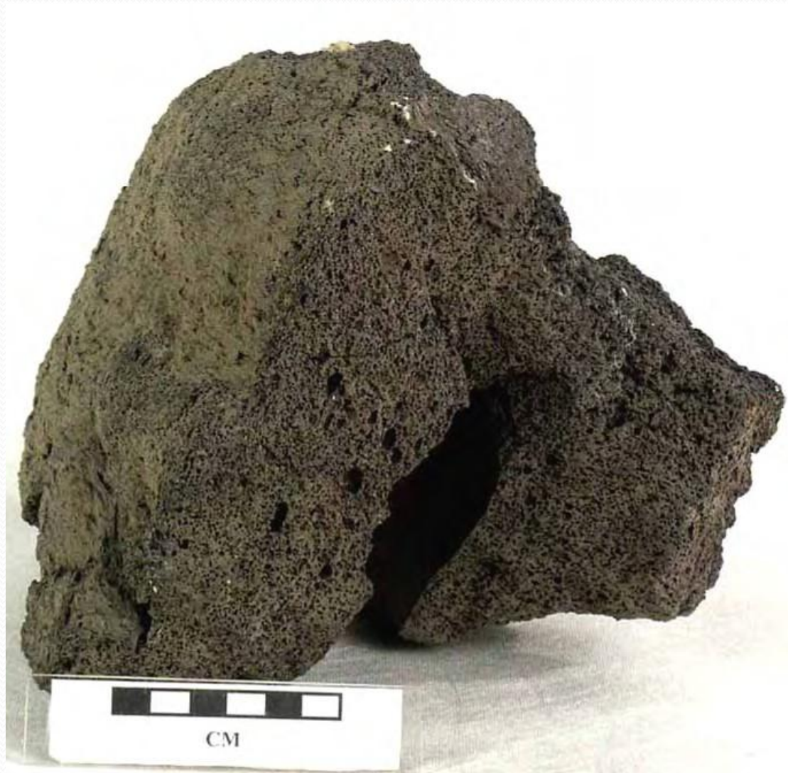
岩石名称：熔岩 英文名称：Lava 颜色：深灰 构造：气孔构造 结构：全玻璃质结构 主要成分：基性玻璃 所属岩类：岩浆岩\基性喷出岩 产地：黑龙江五大连池
