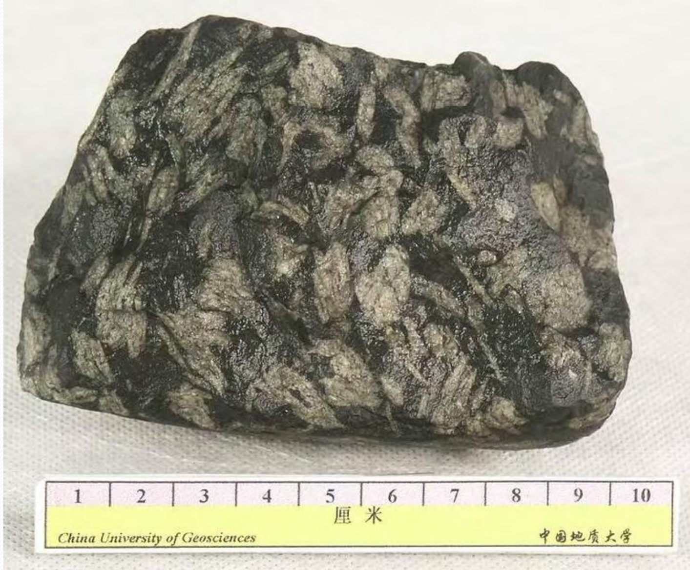
岩石名称：斜长玢岩 英文名称：Plagiophyre 颜色：深灰 构造：块状构造 结构：斑状结构，基质隐晶结构 主要成分：斑晶为斜长石，基质为斜长石、普通角闪石 所属岩类：岩浆岩\基性浅成侵入岩 产地：河北涞源
