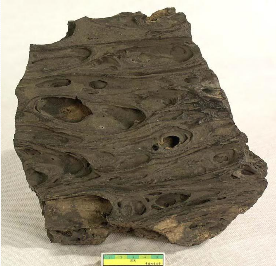
岩石名称：火山熔岩 英文名称：Volcanic lava 颜色：深灰 构造：流痕构造 结构：全玻璃质结构 主要成分：基性玻璃 所属岩类：岩浆岩\基性喷出岩 产地：黑龙江五大连池
