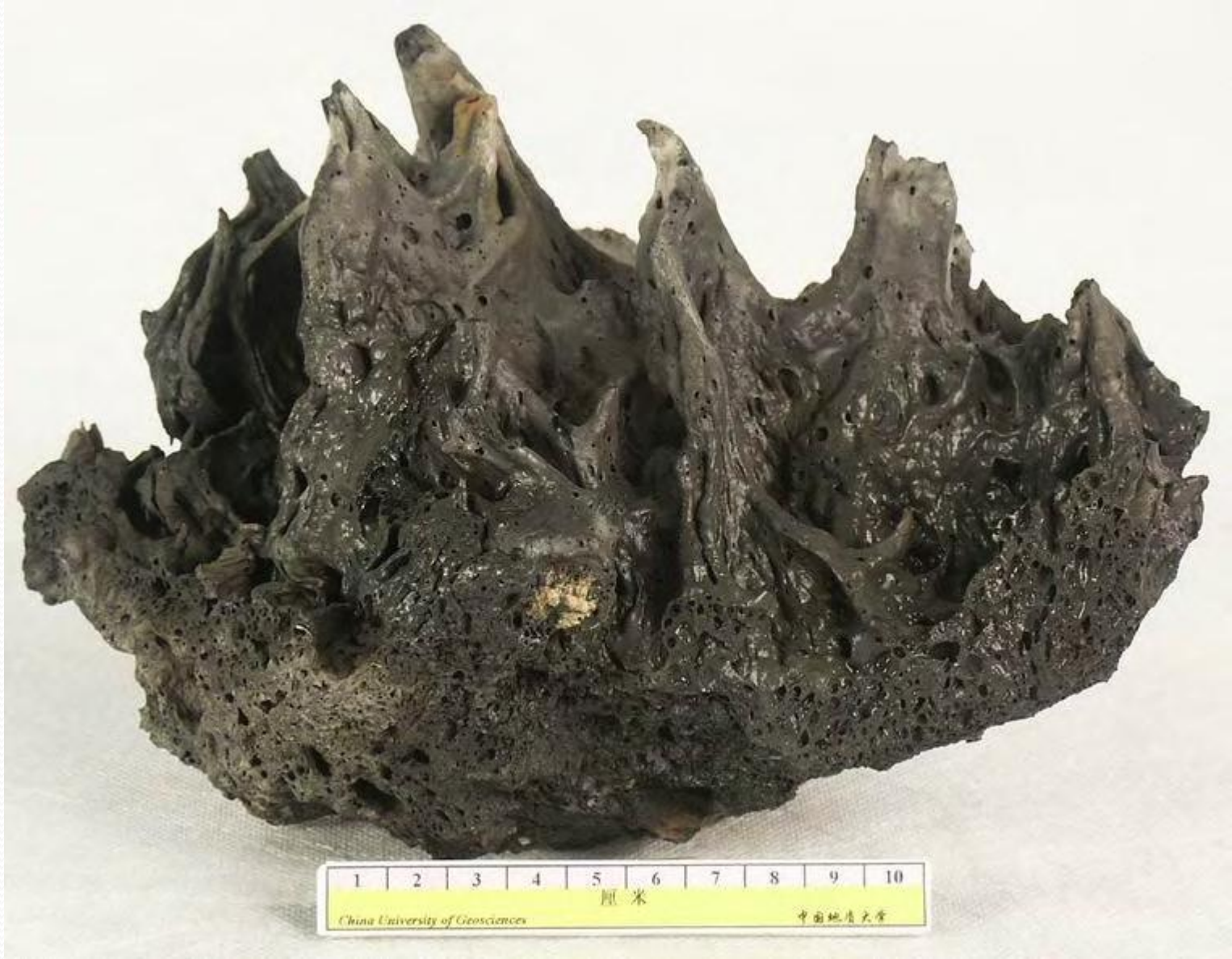
岩石名称：荆棘状玄武岩 英文名称：Thorn-form basalt 颜色：深灰 构造：荆棘状构造 结构：玻璃质结构 主要成分：基性玻璃 所属岩类：岩浆岩\基性喷出岩 产地：黑龙江五大莲池
