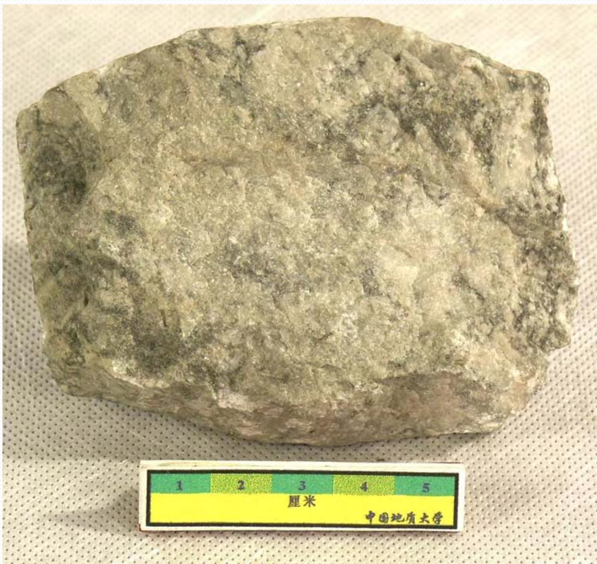
岩石名称：绿泥石化辉长岩 英文名称：Chloritized gabbro 颜色：淡灰 构造：块状构造 结构：粗粒结构 主要成分：普通辉石、基性斜长石、绿泥石 所属岩类：岩浆岩\基性深成侵入岩
