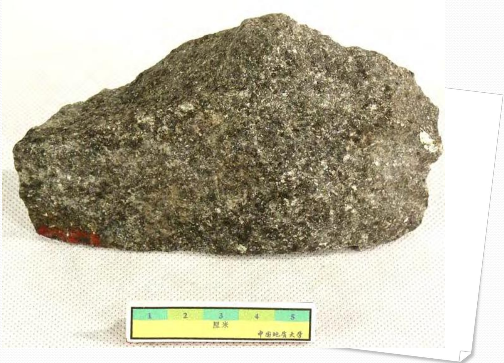
岩石名称：粗粒橄榄辉长岩 英文名称：Coarse olivine-gabbro 颜色：黑灰 构造：块状构造 结构：粗粒结构 主要成分：普通辉石、基性斜长石、橄榄石 所属岩类：岩浆岩\基性深成侵入岩
