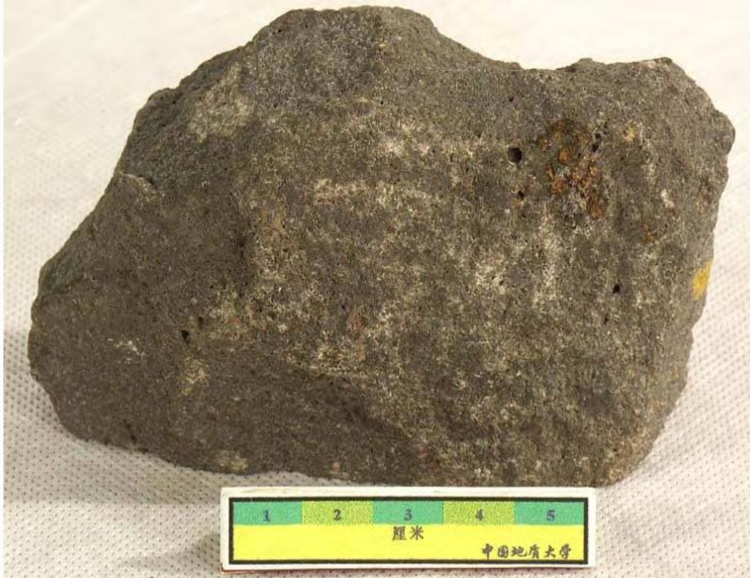
岩石名称：伊丁石化橄榄玄武岩 英文名称：Iddingsitized olivine-basalt 颜色：灰 构造：块状构造，微量气孔 结构：斑状结构，基质隐晶结构 主要成分：斑晶橄榄石（大多伊丁石化），基质斜长石、辉石 所属岩类：岩浆岩\基性喷出岩
