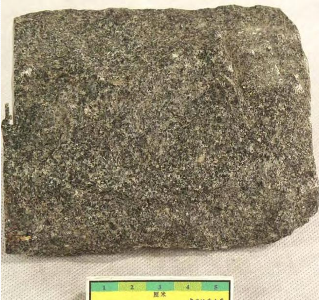
岩石名称：辉长岩 英文名称：Gabbro 颜色：黑灰 构造：块状构造 结构：细粒结构 主要成分：普通辉石、基性斜长石 所属岩类：岩浆岩\基性中深成侵入岩 产地：山东济南
