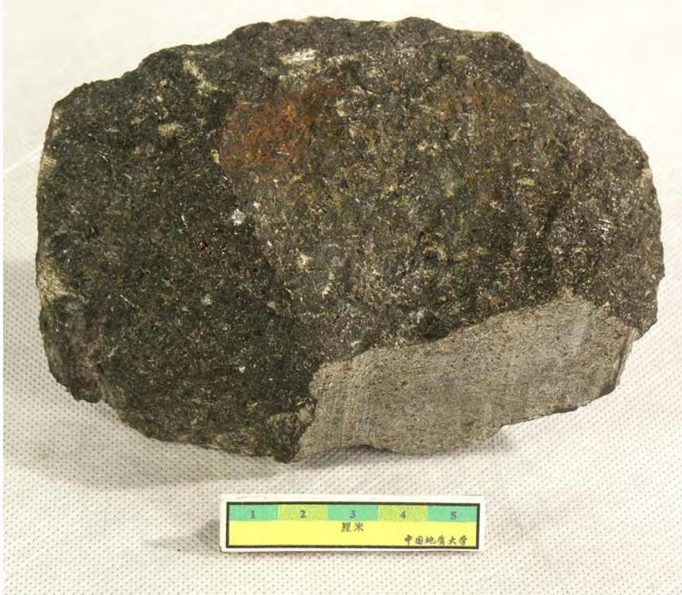
岩石名称：辉绿玢岩 英文名称：Diabase-prophyrite 颜色：灰黑 构造：块状构造 结构：斑状结构，基质微粒结构 主要成分：斑晶斜长石，基质斜长石、辉石 所属岩类：岩浆岩\基性浅成侵入岩 产地：南京下花园
