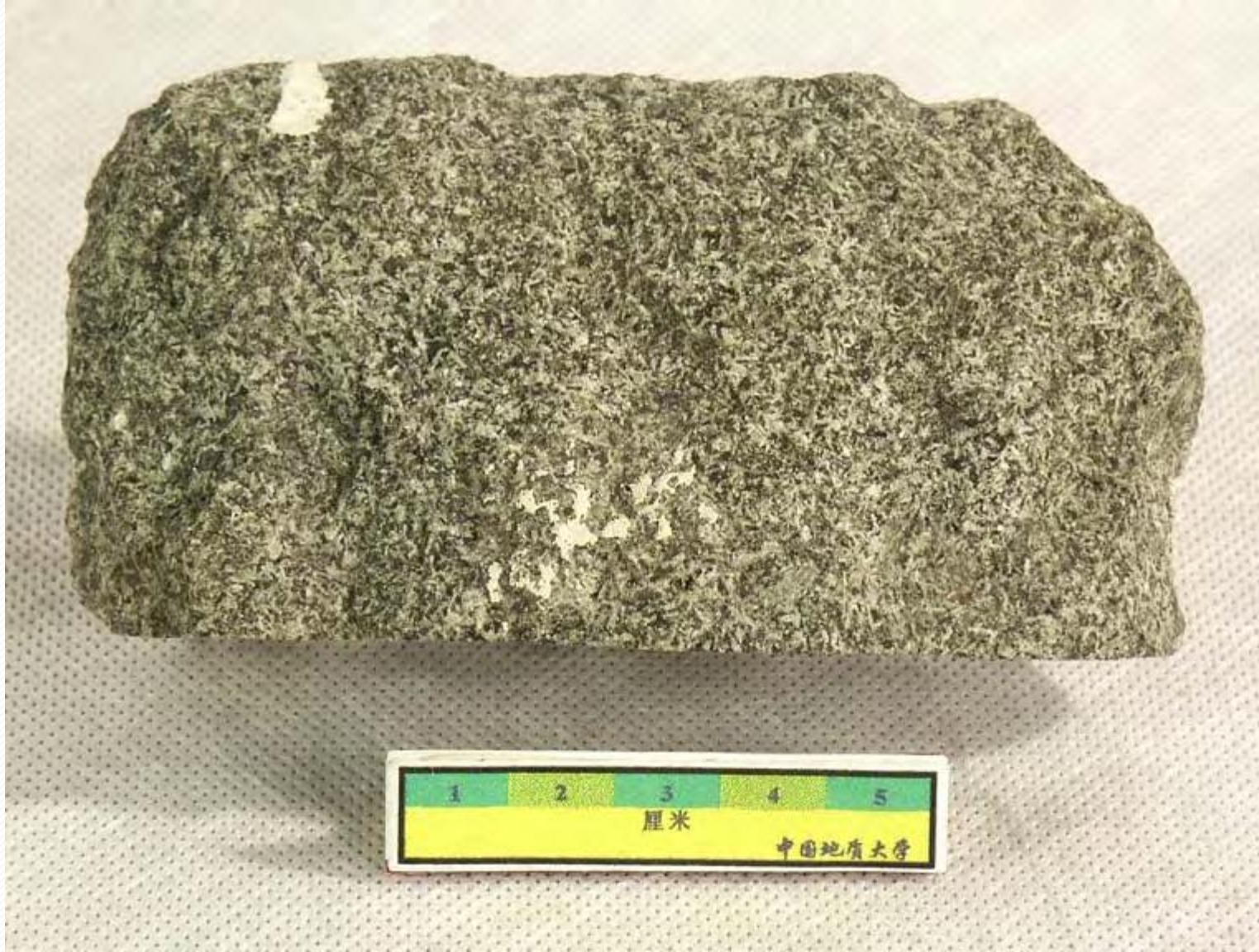
岩石名称：辉绿岩 英文名称：Diabase 颜色：灰 构造：块状构造 结构：微粒结构 主要成分：普通辉石、基性斜长石 所属岩类：岩浆岩\基性浅成侵入岩 产地：南京下花园
