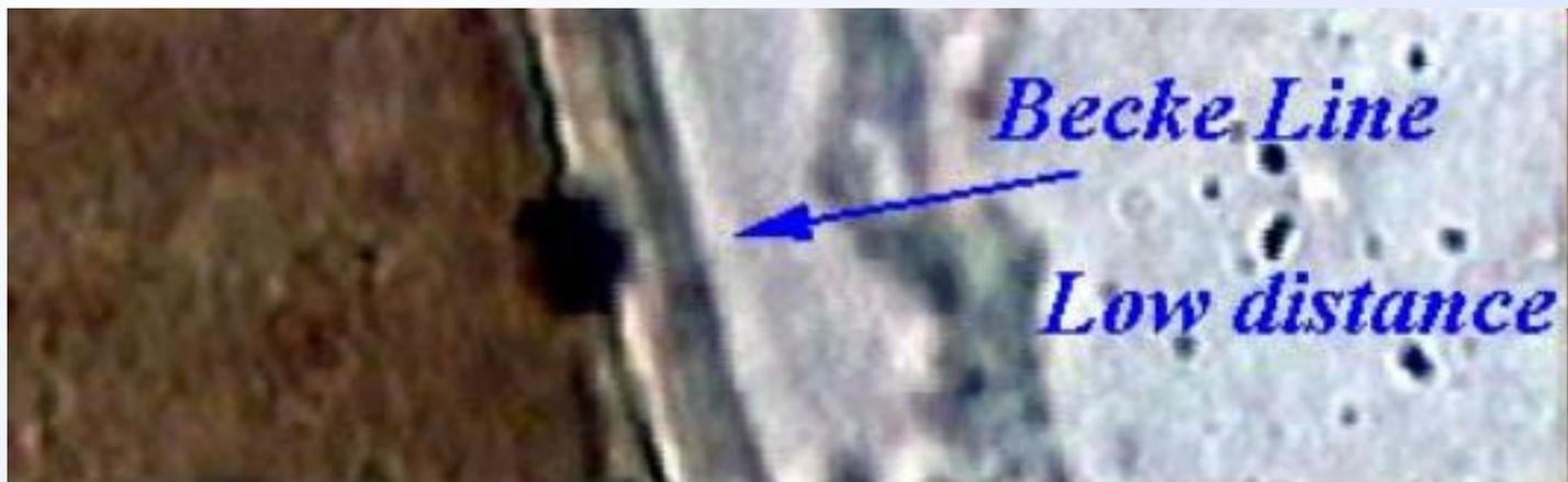
提升目镜镜筒（下降物台）时，贝克线会向折射率较大的矿物移动。据此可判断相邻两物质间折射率的相对大小。
