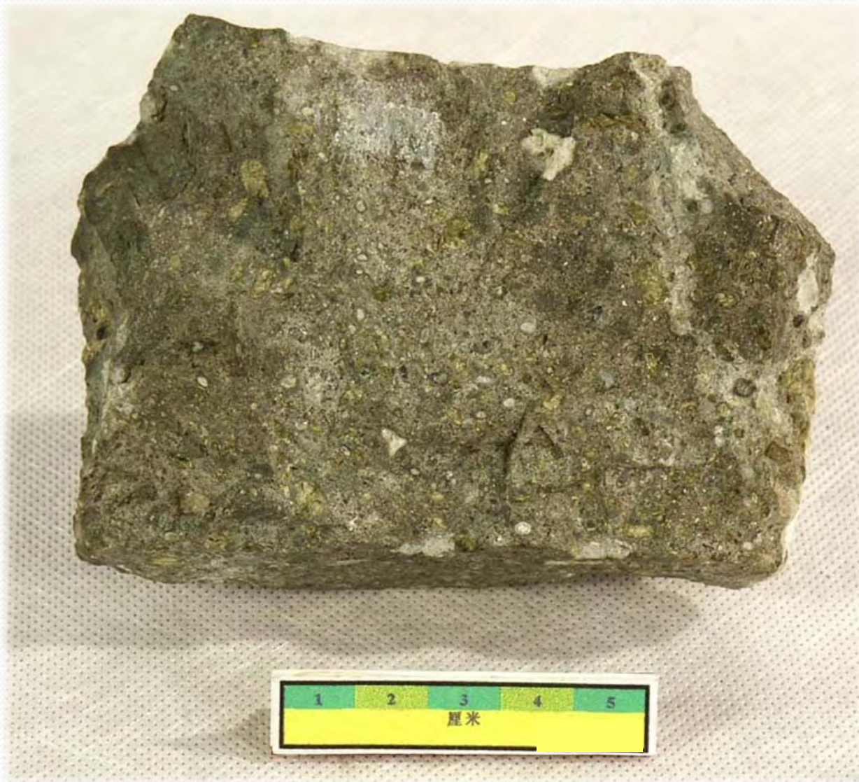
岩石名称：金伯利角砾岩 英文名称：Kimberlitic breccia 颜色：灰黑 构造：块状构造 结构：角砾结构 主要成分：石灰岩角砾（浅灰）、金伯利岩角砾（黑），填隙物 橄榄石、金云母 所属岩类：岩浆岩\超基性超浅成侵入岩 产地：山东
