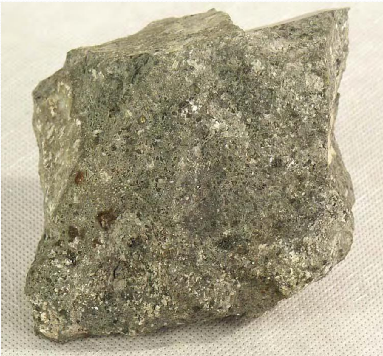
岩石名称：斑状金伯利岩 英文名称：Porphyritic kimberlite 颜色：灰 构造：块状构造 结构：斑状结构，基质微粒结构 主要成分：斑晶橄榄石（蛇纹石化）、透辉石，基质橄榄石（蛇纹石化）、金云母、磁铁矿 所属岩类：岩浆岩\超基性超浅成侵入岩 产地：山东
