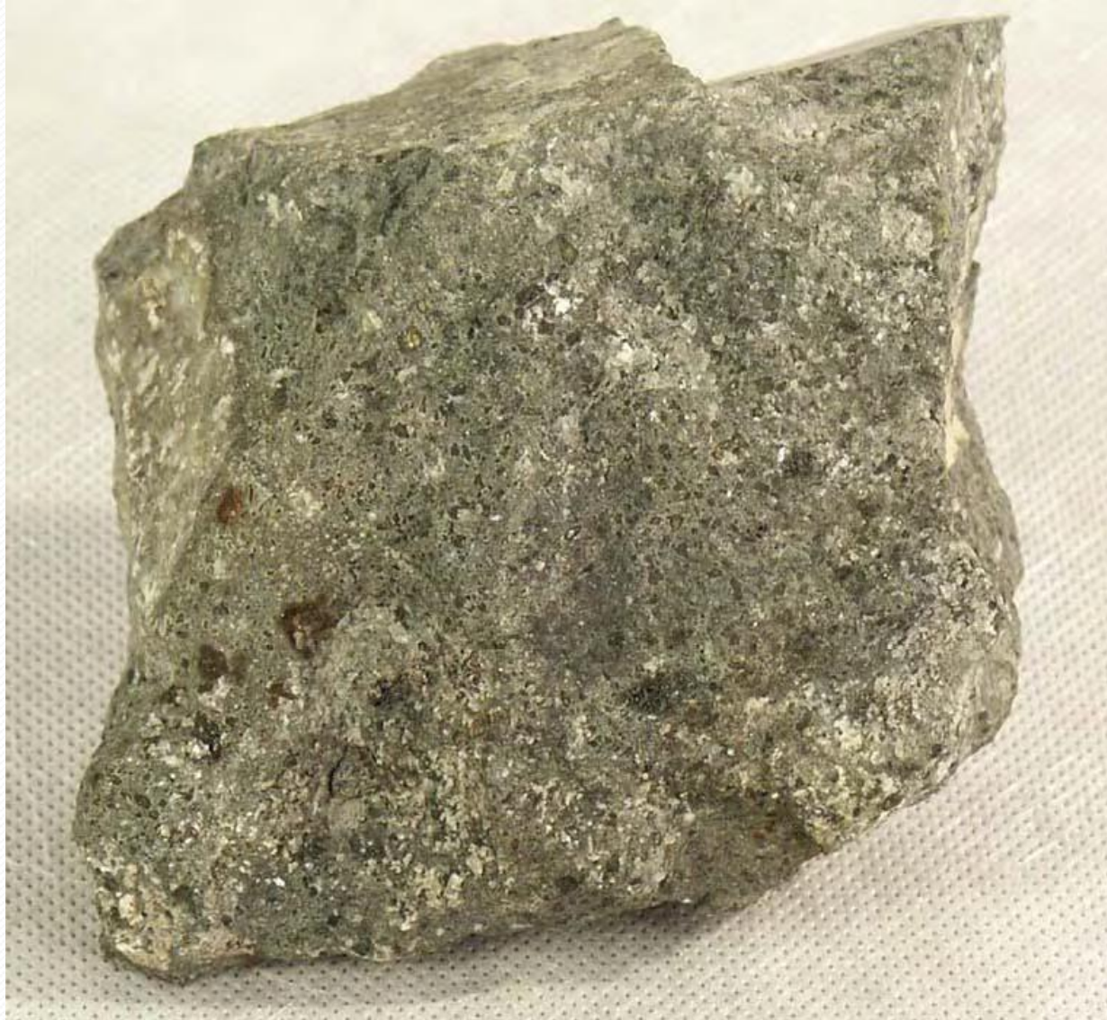
岩石名称：斑状金伯利岩 英文名称：Porphyritic kimberlite 颜色：灰 构造：块状构造 结构：斑状结构，基质微粒结构 主要成分：斑晶橄榄石（蛇纹石化）、透辉石，基质橄榄石（蛇纹石化）、金云母、磁铁矿 所属岩类：岩浆岩\超基性超浅成侵入岩 产地：山东 采集人：山东地质809
