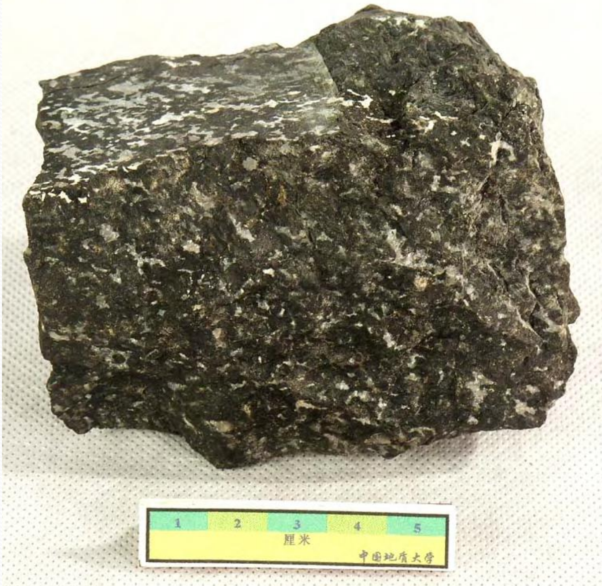
岩石名称：透辉石岩 英文名称：Diapsidite 颜色：灰黑 构造：块状构造 结构：粗粒结构 主要成分：透辉石 所属岩类：岩浆岩\超镁铁质深成侵入岩 产地：河北大庙
