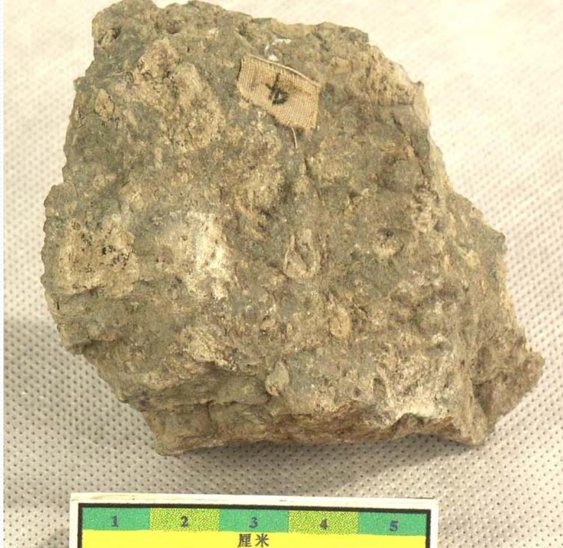
岩石名称：碳酸岩化金云母透辉石金伯利岩 英文名称：Carbonatized phlogopite-diopside-kimberlite 颜色：浅灰黄 构造：块状构造 结构：角砾结构 主要成分：橄榄石、透辉石（均已碳酸岩化、蛇纹石化）、金云母，石灰岩角砾 所属岩类：岩浆岩\超基性超浅成侵入岩
