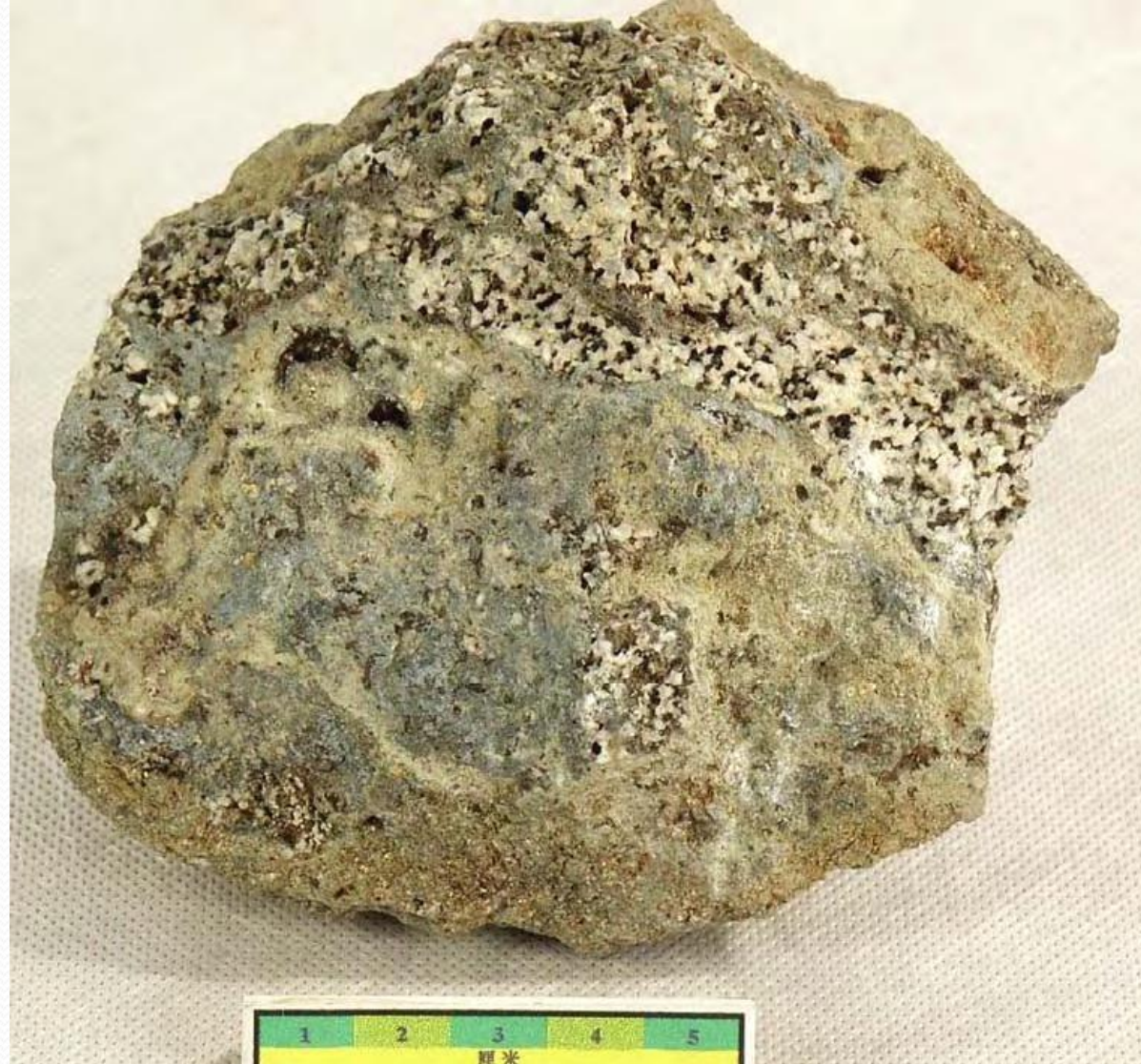
岩石名称：蚀变黑云母碳酸岩 英文名称：Altered biotite-carbonatite 颜色：浅灰绿 构造：块状构造 结构：中粒结构 主要成分：方解石、黑云母（部分已退色） 所属岩类：岩浆岩\超基性深成侵入岩 产地：山东莱芜
