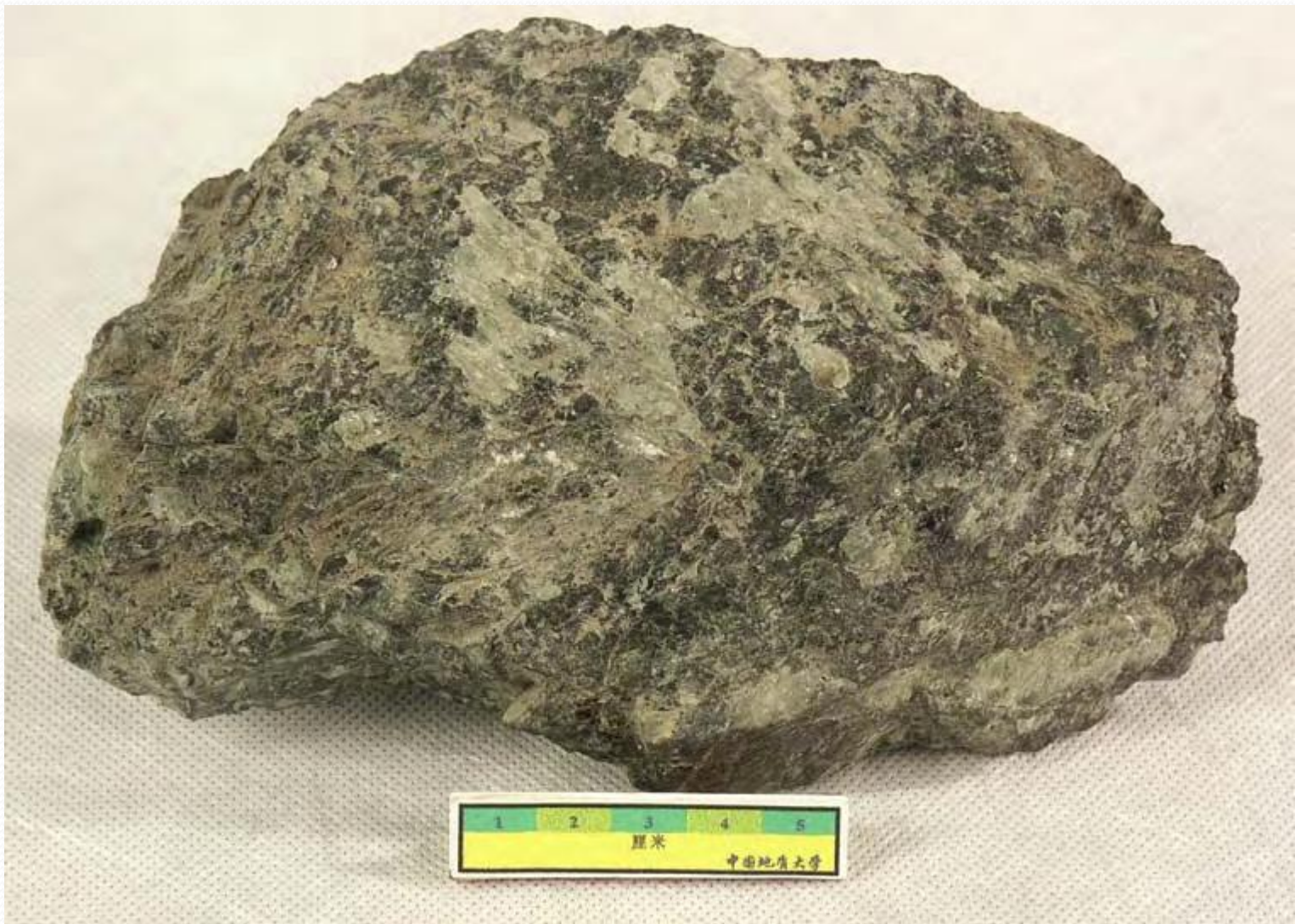
岩石名称：辉石角闪石岩 英文名称：Pyroxene bornblende 颜色：黑灰 构造：块状构造 结构：粗粒结构 主要成分：角闪石（部分绿泥石化），辉石 所属岩类：岩浆岩\超镁铁质深成侵入岩 产地：河北大庙
