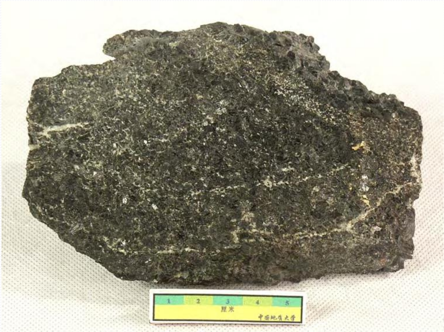
岩石名称：角闪石岩 英文名称：Hornblendite 颜色：灰黑 构造：块状构造 结构：中粒结构 主要成分：普通角闪石 所属岩类：岩浆岩\超镁铁质深成侵入岩 产地：辽宁清源
