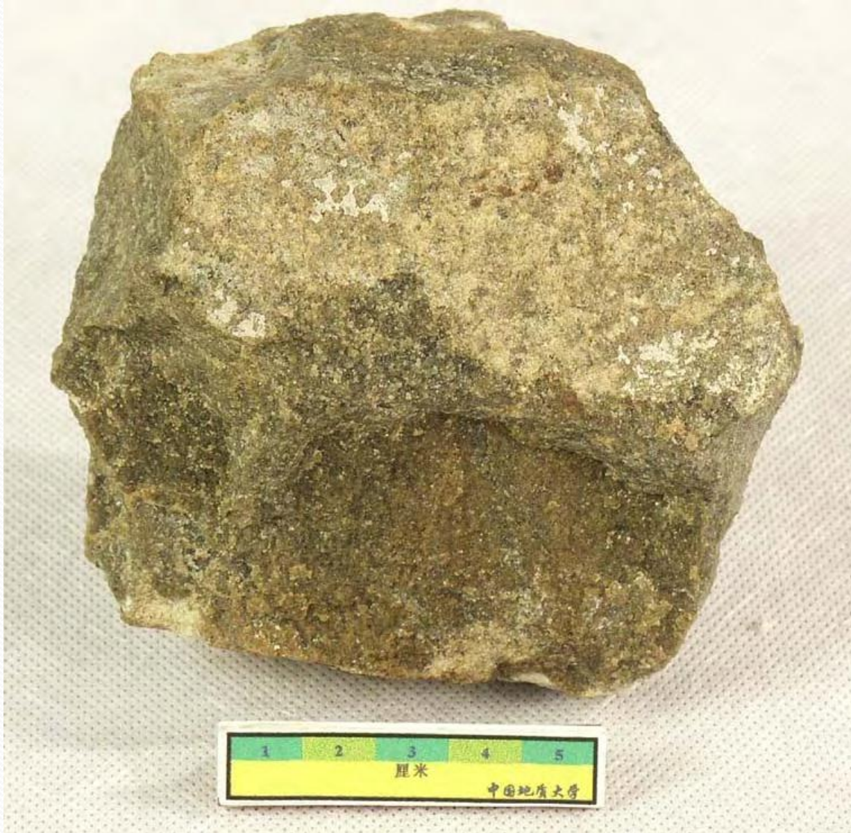
岩石名称：巨晶纯橄岩 英文名称：Macrocrystalline dunite 颜色：暗黄褐 构造：块状构造 结构：巨粒结构 主要成分：橄辉石（部分蛇纹石化） 所属岩类：岩浆岩\超镁铁质深成侵入岩 产地：湖北宜昌太平溪梅子厂
