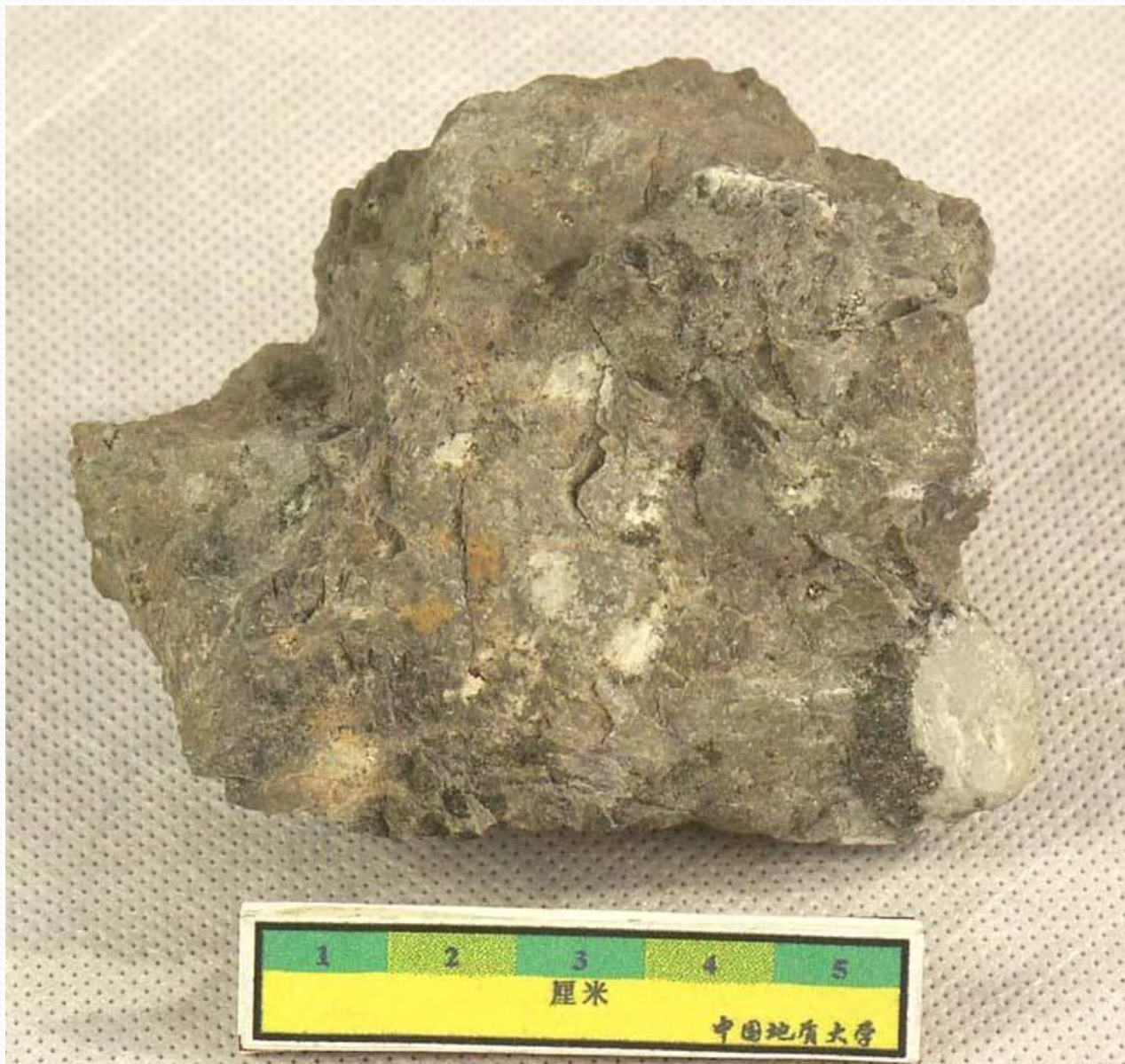
岩石名称：辉石橄榄岩 英文名称：Pyroxene peridotite 颜色：浅灰，泛绿 构造：块状构造 结构：粗粒结构 主要成分：橄榄石（部分蛇纹石化），辉石 所属岩类：岩浆岩\超镁铁质深成侵入岩
