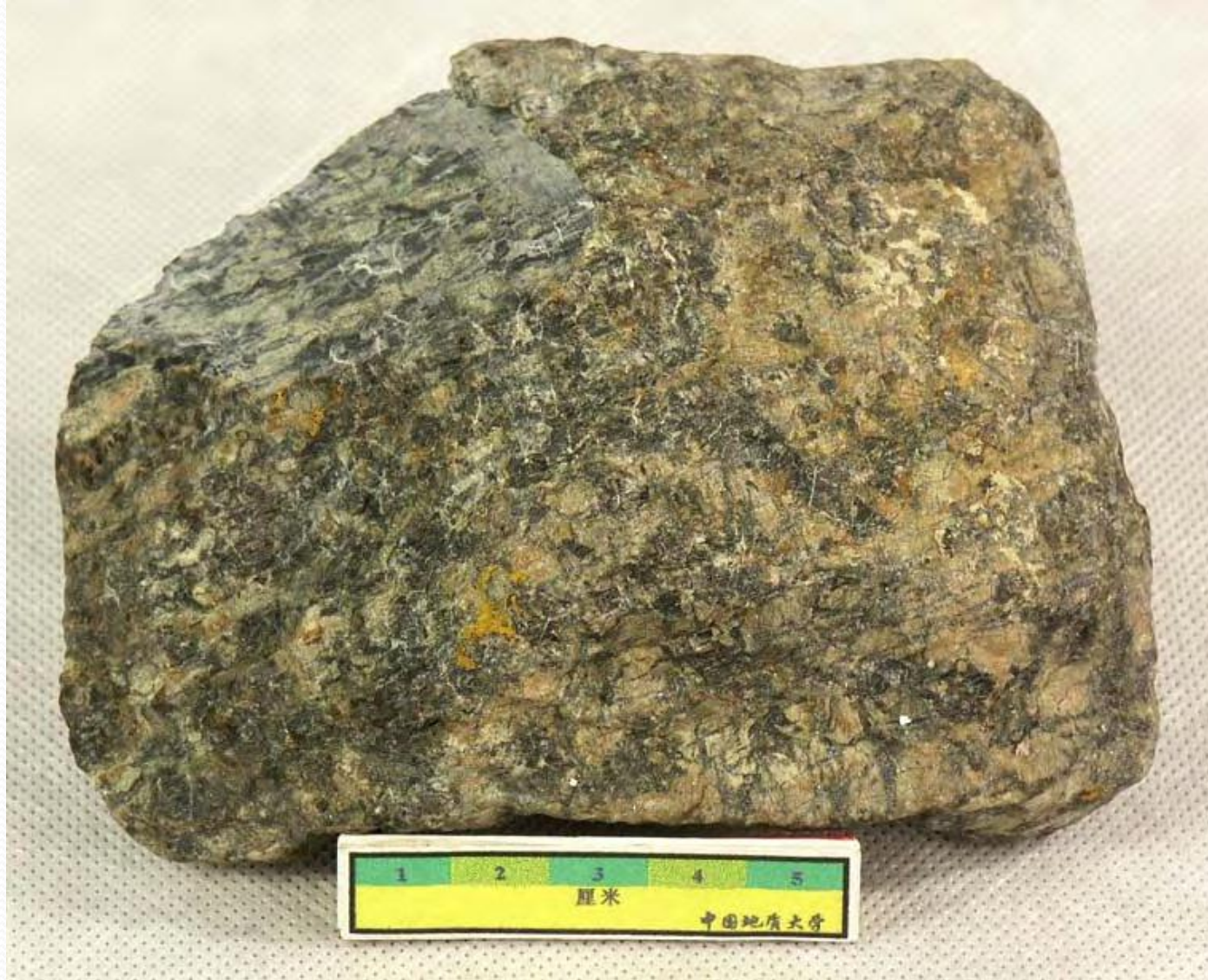
岩石名称：蛇纹石化橄榄岩 英文名称：Serpentinized peridotite 颜色：深灰 构造：块状构造 结构：粗粒结构 主要成分：橄榄石，蚀变蛇纹石 所属岩类：岩浆岩\超镁铁质深成侵入岩 产地：山东营南县王家大山
