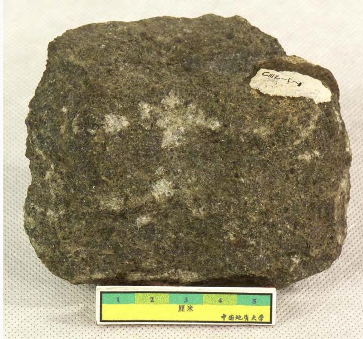
岩石名称：斜长橄榄岩 英文名称：Plagioclase peridotite 颜色：黑灰 构造：块状构造 结构：细粒结构 主要成分：橄榄石，基性斜长石 所属岩类：岩浆岩\超镁铁质层状侵入岩
