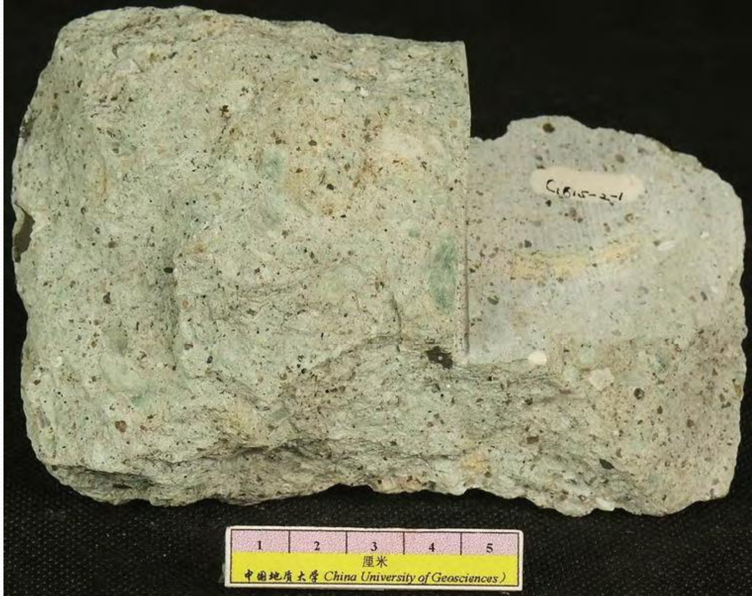
岩石名称：晶屑凝灰岩 英文名称：Crystal tuff 颜色：淡绿 构造：块状构造 结构：凝灰结构 主要成分：石英、长石晶屑，火山尘 所属岩类：岩浆岩\火山碎屑岩 产地：河北宣化
