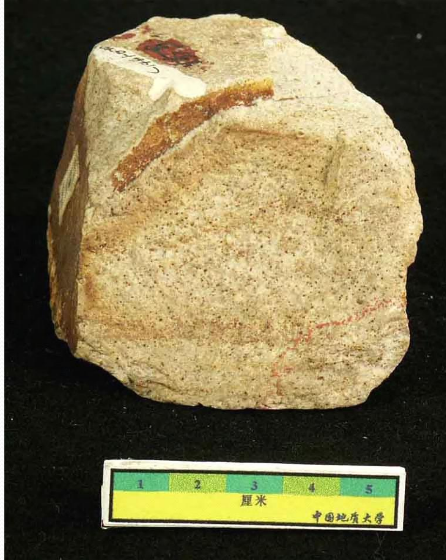
岩石名称：霏细岩 英文名称：Felsite 颜色：淡褐白 构造：块状构造 结构：隐晶结构 主要成分：长石、石英 所属岩类：岩浆岩\酸性喷出岩 产地：北京青龙桥
