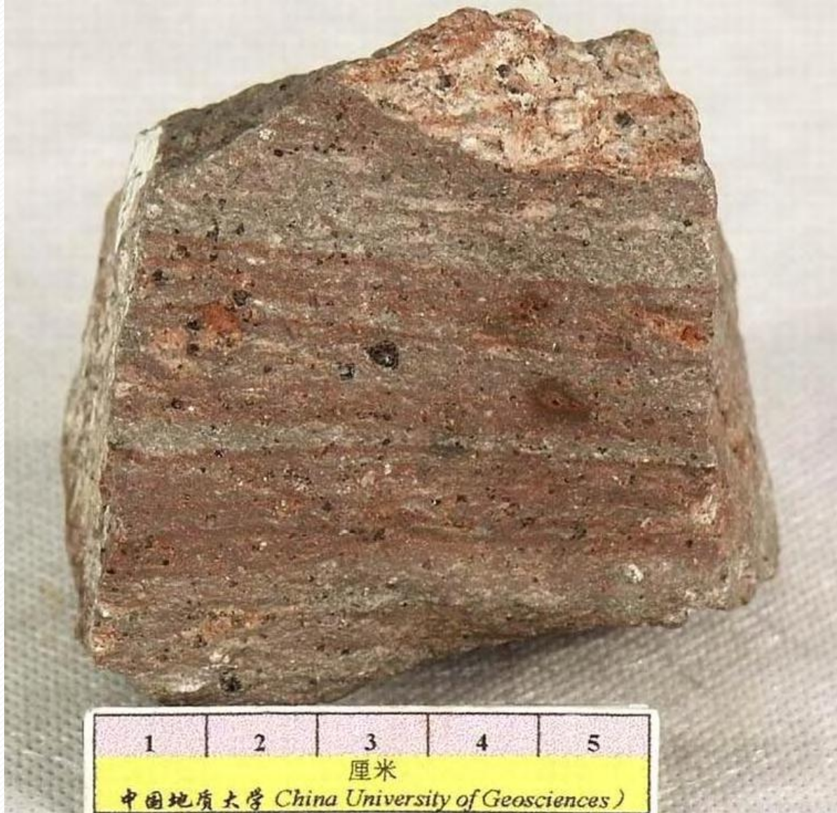
岩石名称：流纹岩 英文名称：Rhyolite 颜色：浅褐红 构造：流纹构造 结构：斑状结构，基质玻璃质结构 主要成分：斑晶石英、透长石，基质酸性玻璃 所属岩类：岩浆岩\酸性喷出岩 产地：河北宣化
