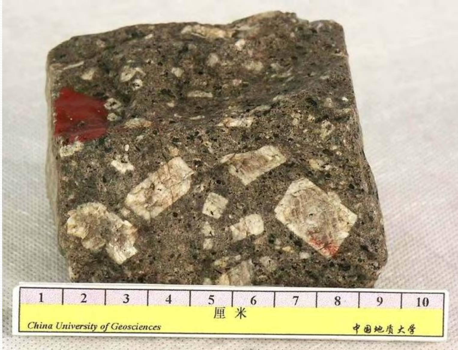
岩石名称：花岗斑岩 英文名称：Granite-porphyry 颜色：浅灰 构造：块状构造 结构：斑状结构，基质隐微粒结构 主要成分：斑晶碱性长石、石英，基质同斑晶 所属岩类：岩浆岩\酸性浅成侵入岩 产地：北京八达岭
