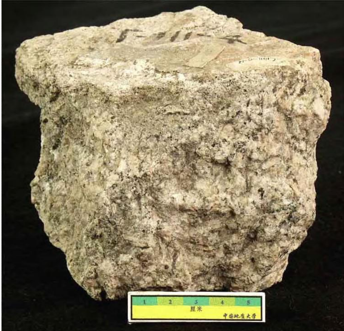
岩石名称：斑状花岗岩及暗色包体 英文名称：Porphyritic granite and dark inclusion 颜色：淡灰褐，包体灰 构造：块状构造 结构：似斑状结构，基质粗粒结构 主要成分：斑晶钾长石，基质石英、钾长石、黑云母，包体斜长石、角闪石 所属岩类：岩浆岩\酸性深成侵入岩 产地：深圳
