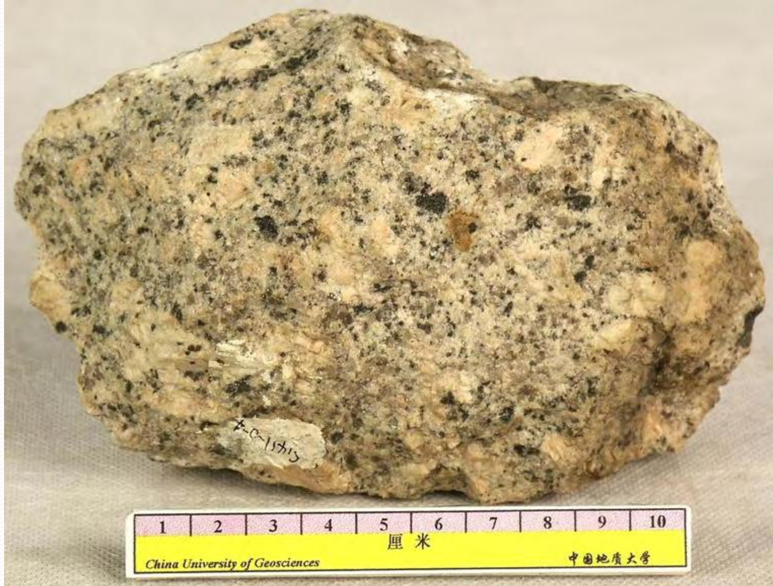
岩石名称：斑状花岗岩 英文名称：Porphyritic granite 颜色：淡褐黄 构造：块状构造 结构：似斑状结构 主要成分：长石、石英、黑云母 所属岩类：岩浆岩\酸性深成侵入岩 产地：广西富钟
