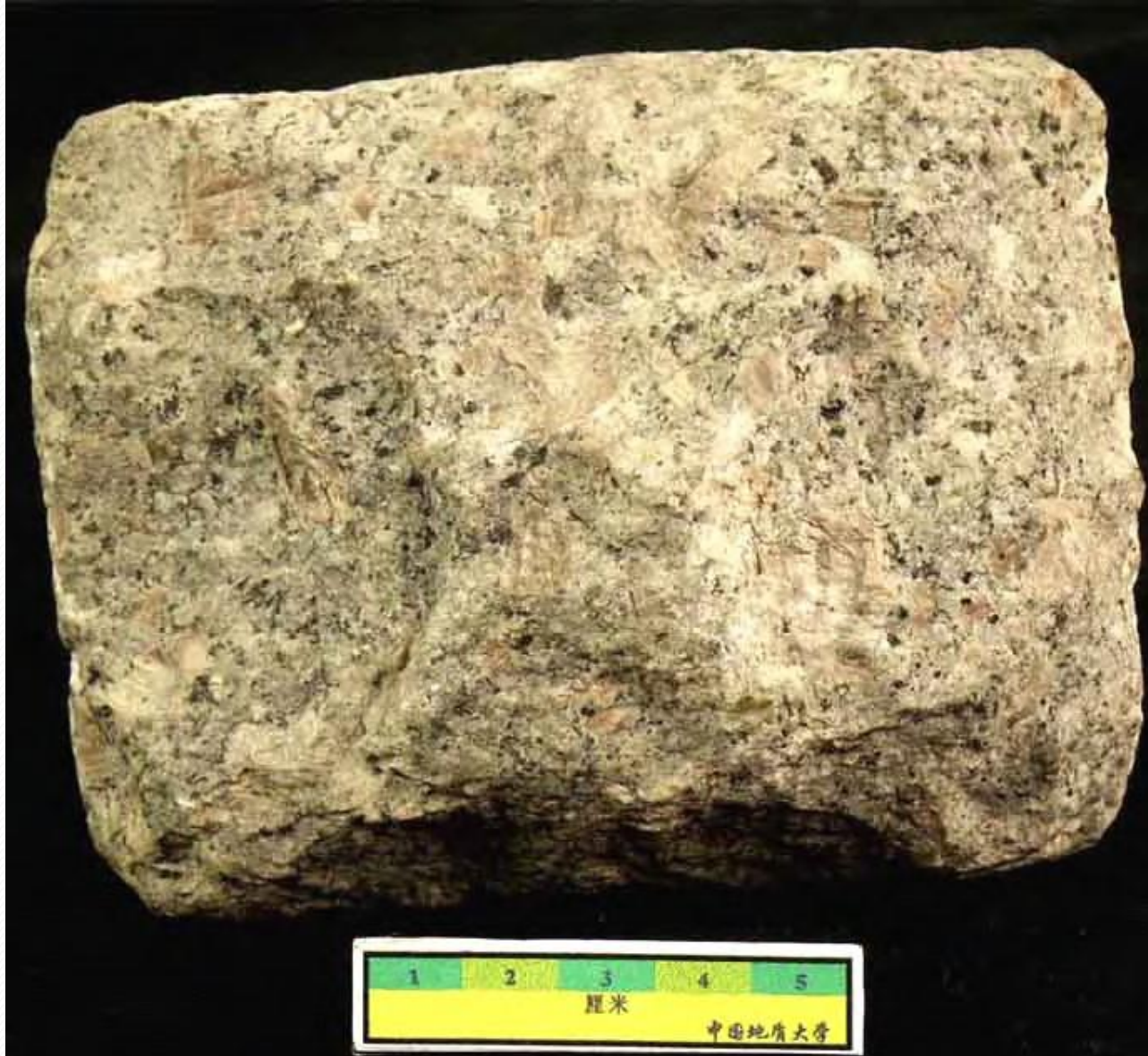
岩石名称：斑状花岗岩 英文名称：Porphyritic granite 颜色：浅灰，泛褐 构造：块状构造 结构：似斑状结构，基质中粒结构 主要成分：斑晶钾长石，基质石英、钾长石、斜长石、黑云母 所属岩类：岩浆岩\酸性深成侵入岩
